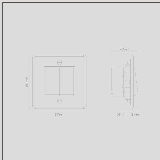
Cet interrupteur va et vient carré x2 sur plaque simple ne fait que 2 mm d'épaisseur de sorte qu'il est pratiquement invisible sur le mur.
