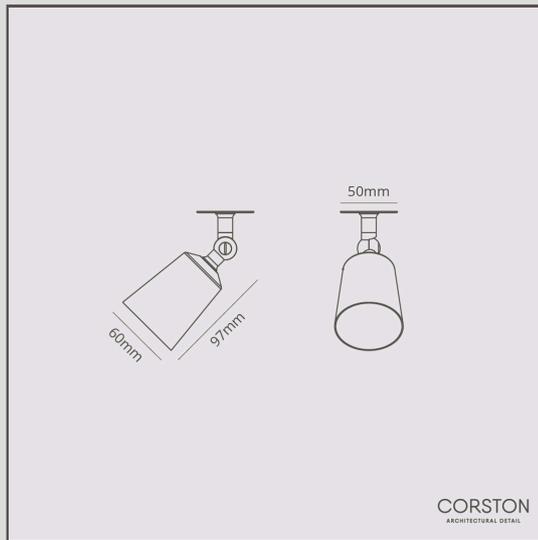
Les connexions électriques du Spot Simple Perryn sont dissimulées, tandis qu'un mécanisme à ressort permet de fixer la plaque de montage à un plafond en plaques de plâtre.
