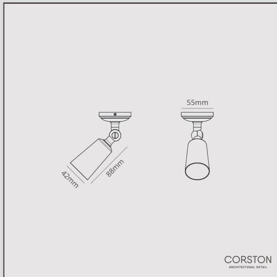
Le Petit Spot Simple Baylis s'installe facilement avec une petite rosace et des vis de fixation discrètes.
