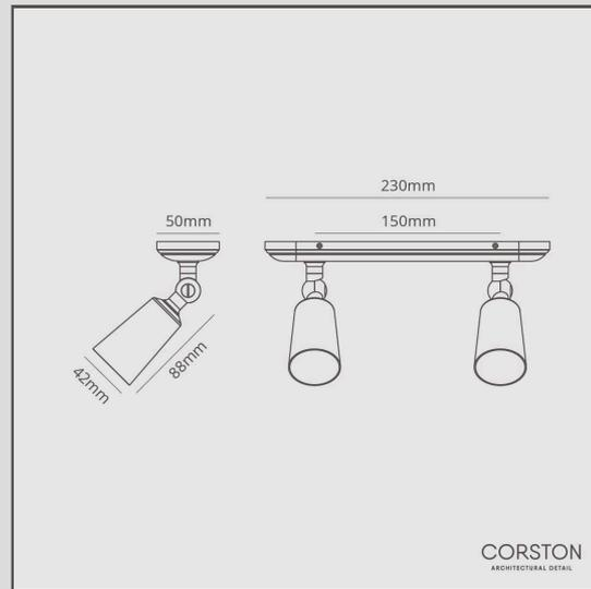
Der kleine Deckenstrahler Baylis wird mit einer kleinen Grundplatte, in der die Schrauben versteckt sind, bündig an der Wand befestigt. Sein leichtgängiges Kugelgelenk lässt sich um 320 Grad drehen und um 180 Grad neigen, um bestimmte Bereiche eines Raumes zu beleuchten.
